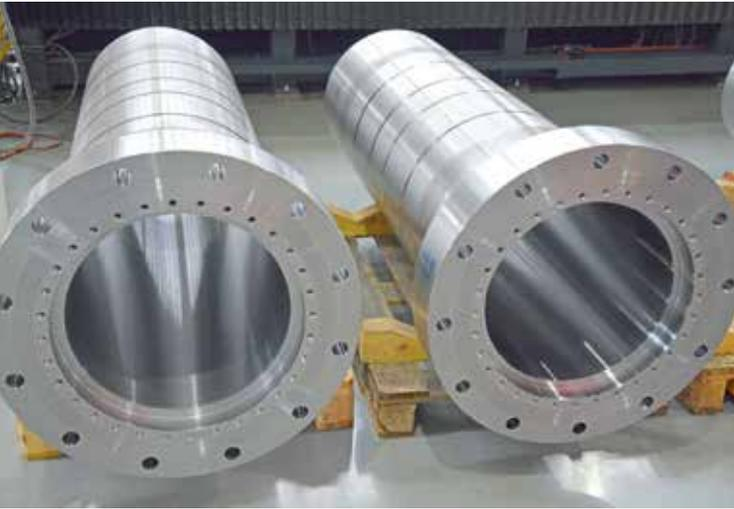
**2** Rohre für Hydraulikzylinder: Die sensible Prozessführung beim Pressen von Composite-Bauteilen erfordert eine hohe Bearbeitungsgenauigkeit der Komponenten, die Matec mit dem stufenlos zweiachsig schwenkbaren HVU-Kopf sicherstellen kann (© Hanser)
